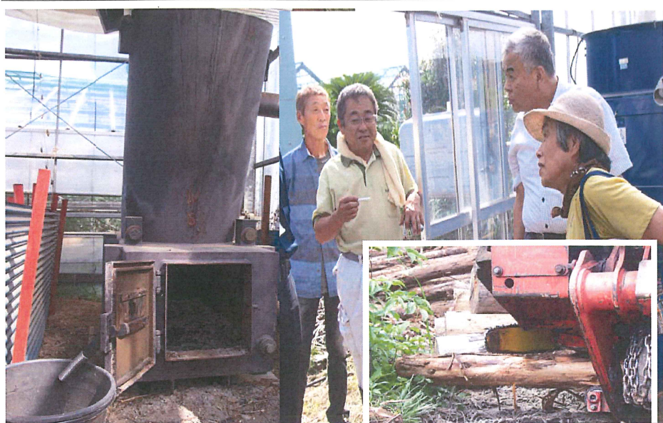
左から8時間連続燃焼時間のストーブ「ゴロン太」改良型は12時間に延長。説明する花卉農家の軽込さん。右下は、木材を一定の長さに切り分ける、チェーンソー付の工作機械。
