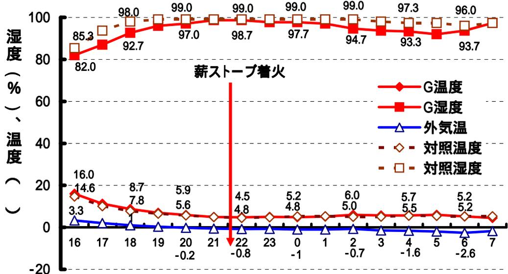
図1 展示施設の夜間温湿度(3ヶ所平均)と外気温の推移 (H25 1月9～10日、16～7時)
